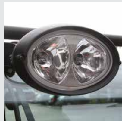
2 arbejdslys forud og en bagud
