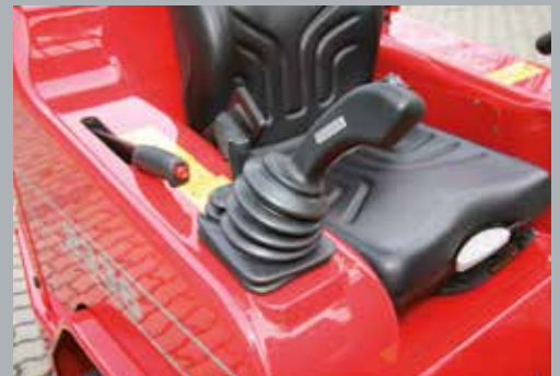
Joystick og håndbremse er ergonomisk placeret på højre side af maskinen.
