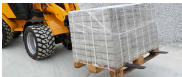
Schaeffer 3450S løfter og håndterer paller på 2.0 ton. Den smalle og lave forende og tårn giver føreren optimalt udsyn til redskaber og last.
