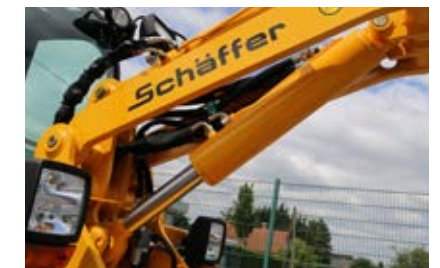
Løftcylinderen er specielt dimensioneret til de store løft og monteret med kugleled som beskyttelse mod vrid og slid.
