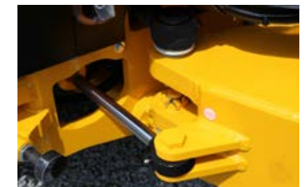
Det hydrauliske knækked med pendling er vedligeholdelsesfrit og med udvidet garanti.
