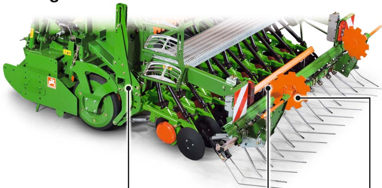
Hydraulisk indstilling af skærtryk
