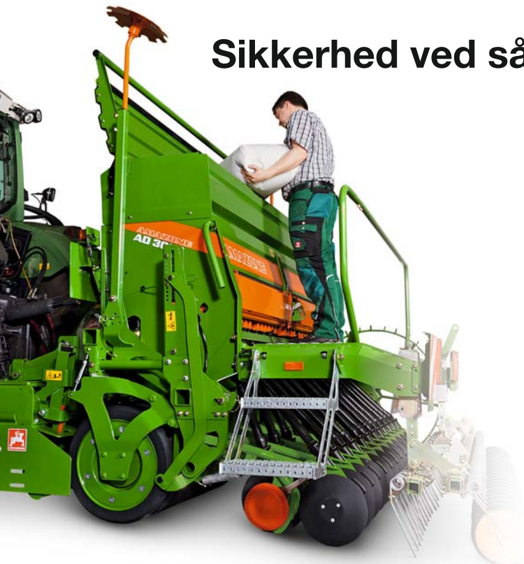
Påfyldningshjælpen gør det lettere at fylde såkassen med sækkevarer.
