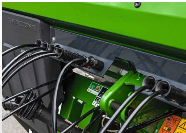
Overskueligt tilslutningspanel til hydraulikslanger
