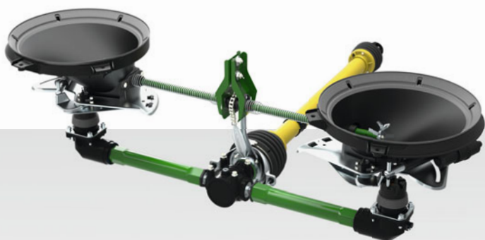
Skematisk illustration af den mekanisk drevne ZA-V
