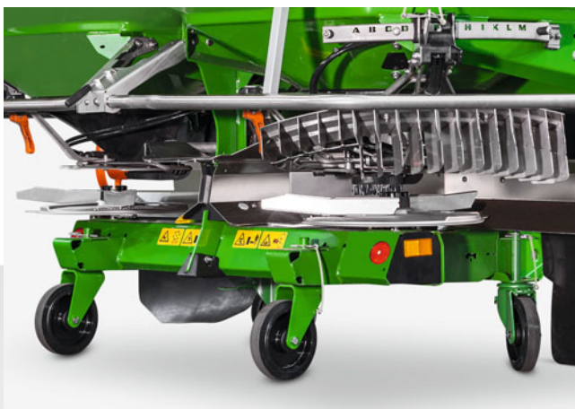
Special-ramme med rulle- og parkeringsanordning
