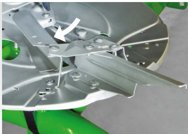
AutoTS – indstilling af indføringsskovlen til grænsespredning
