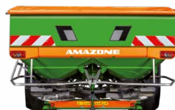
Beholder S 2600 (påfyldningsbredde 2,22 m) med sammenklappelig stige i køreretning til venstre
