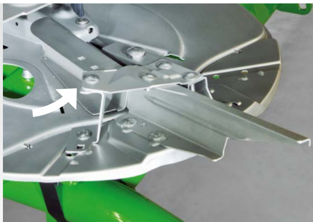
AutoTS – indstilling til normalspredning
