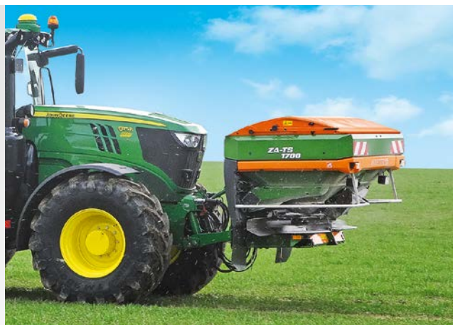
Frontspredere med egnet belysningssystem til kørsel på offentlig vej
