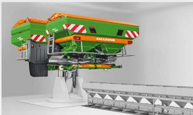
Moderne testhal til gødningspredere
