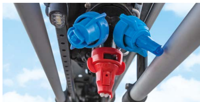
✓ AmaSwitch 3-dobbelt dyseholder med LED-enkeltdysebelysning
