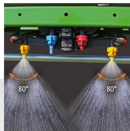
Elektrisk enkeltdyseaktivering med AmaSelect med 4-vejs dyseholder og dyseafstand på 50 cm eller 25 cm
