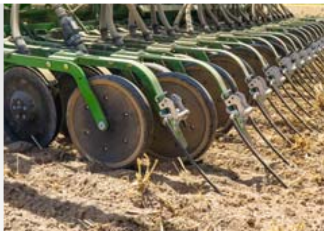
Skærstrigle på TwinTeC-skær
