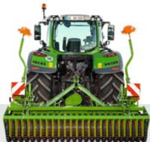
KG 3001 Super med markør og kileringsvalse med matrixdækprofil KWM 600
