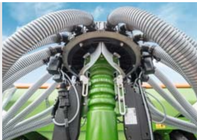
Segmentfordelerhoved med elektrisk halvsideaktivering
