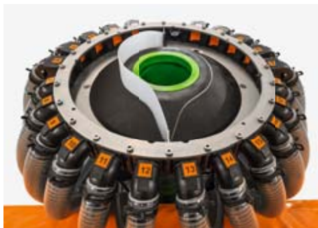
Segmentfordelerhoved med elektrisk halvsideaktivering (aktiveret)
