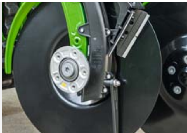
Indvendig afstryger af hårdtmetal (specialudstyr)
