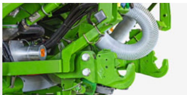
Gribecløer for tilkobling af bugseret Cenius-2TX
