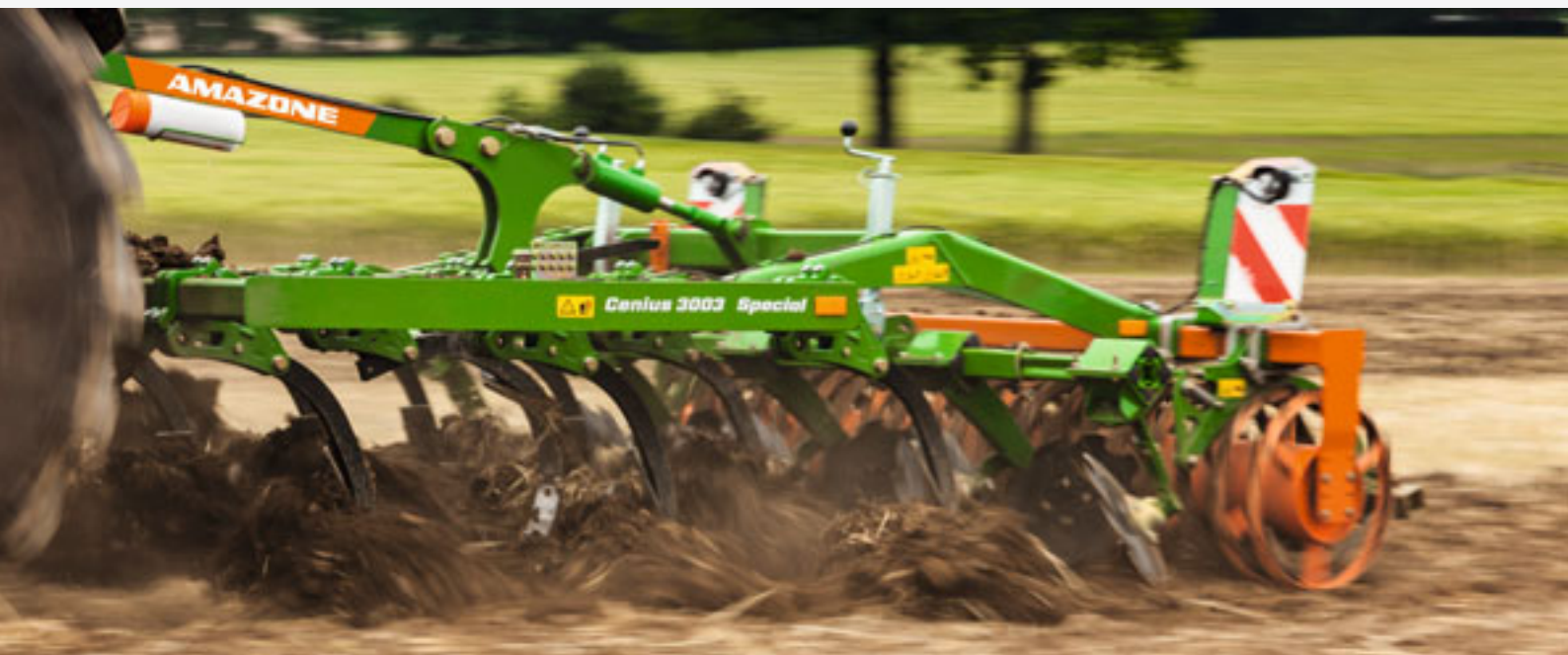
Cenius 3003 Special med C-Mix-Special-tænder
