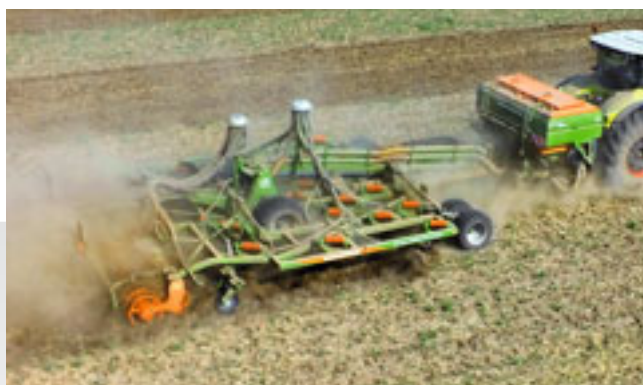
XTender 4200 med Cenius 6003-2TX og to fordelerhoveder til gødningsplacering og udlægning af såsæd
