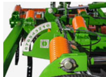
! »Den laserskårne, halvrunde skala til udjævningen er i top.«
