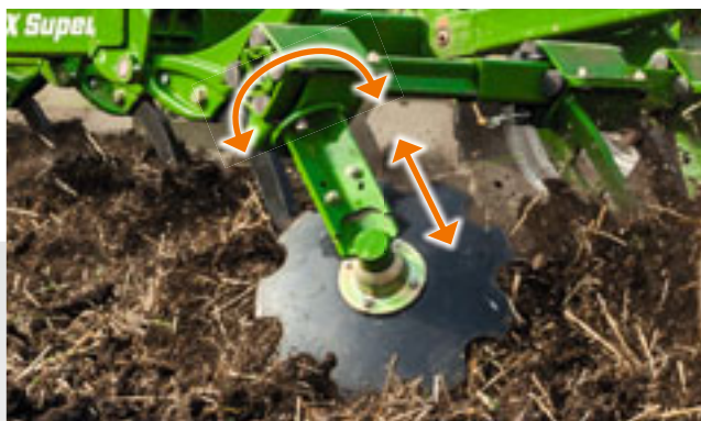
Sideudjævner – højde og hældning kan indstilles separat
