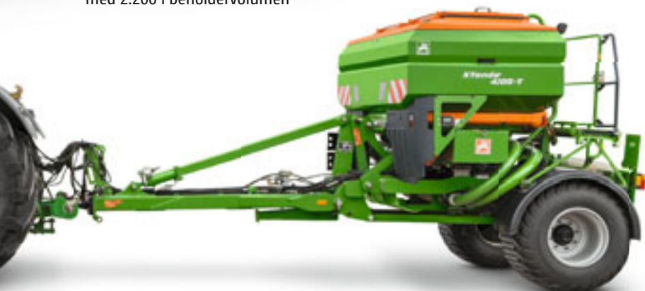
Påbygningsbeholder XTender 2200 med 2.200 l beholdervolumen
