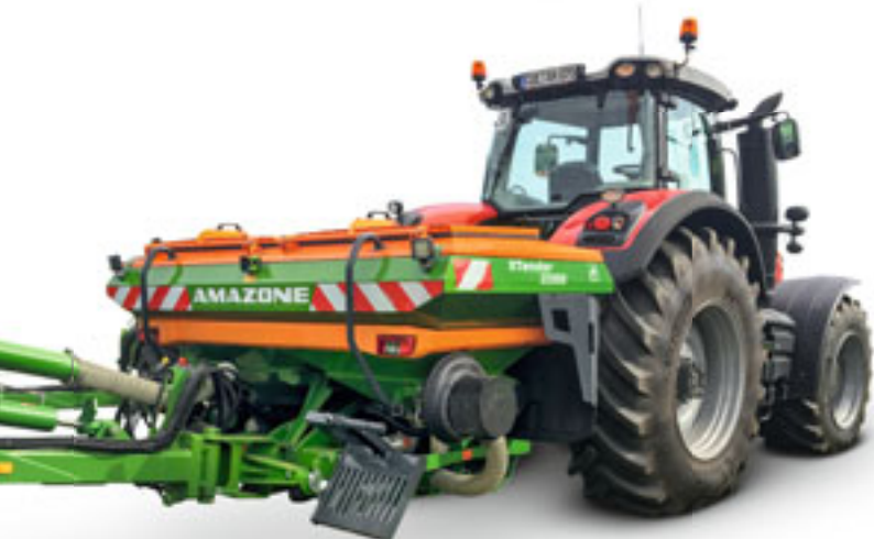
Påbygningsbeholder XTender 2200 med 2.200 l beholdervolumen
